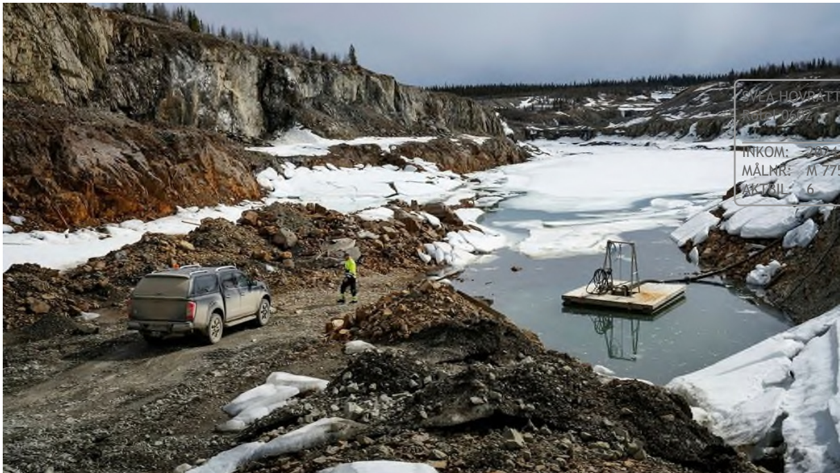
Kenth Ackemo har kontrollerat en pump vid det gamla dagbrottet. Pumpen ska se till att dagbrottet inte svämmar över när snösmältningen sätter igång för fullt. Foto: Erik Abel
