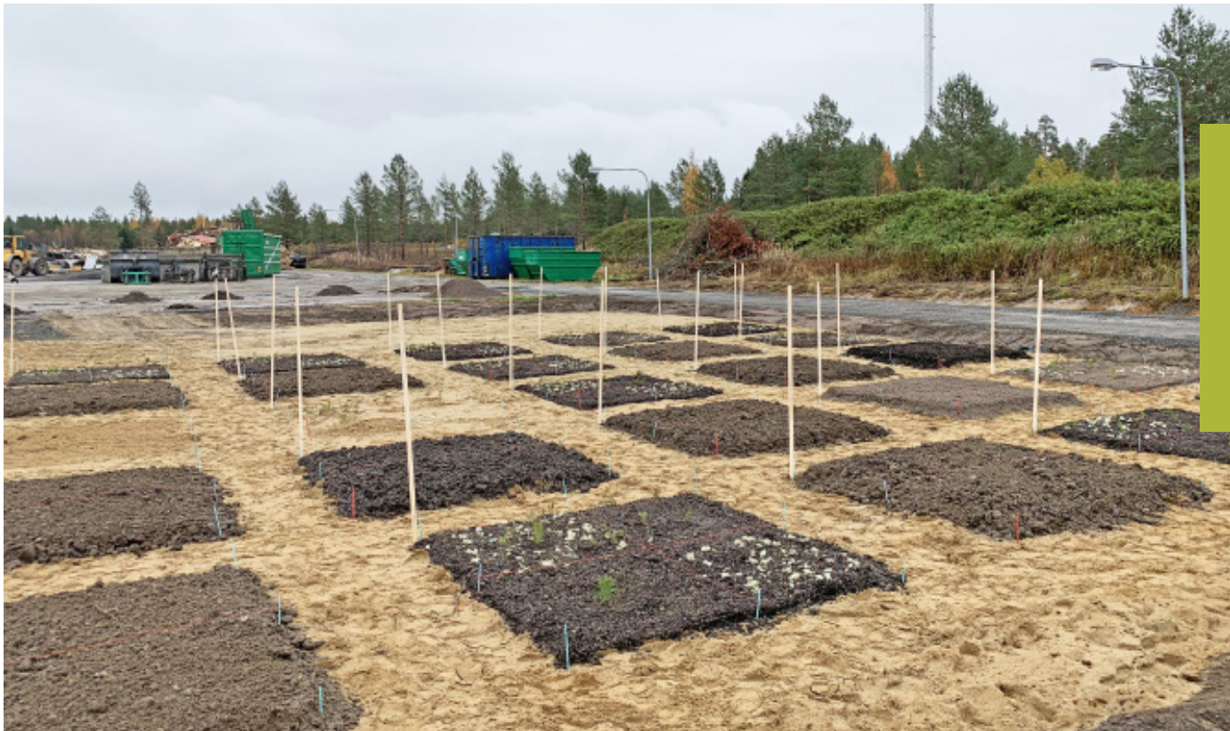
FIGUR 15 Försöksrutor där metoder för växtetablering testas på olika jordblandningar-bygger värdefull kunskap inför ekologisk landskapsutformning.
