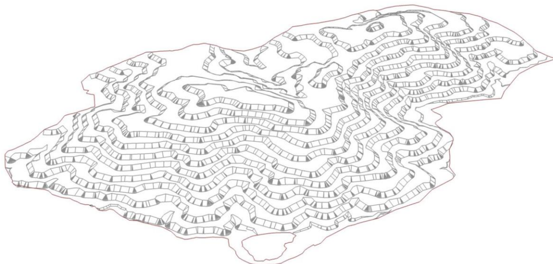
Figur 11 Exempel på deponeringsplan med terrassering (organisk form) för den norra gråbergsdeponin (VAST, 2021).
