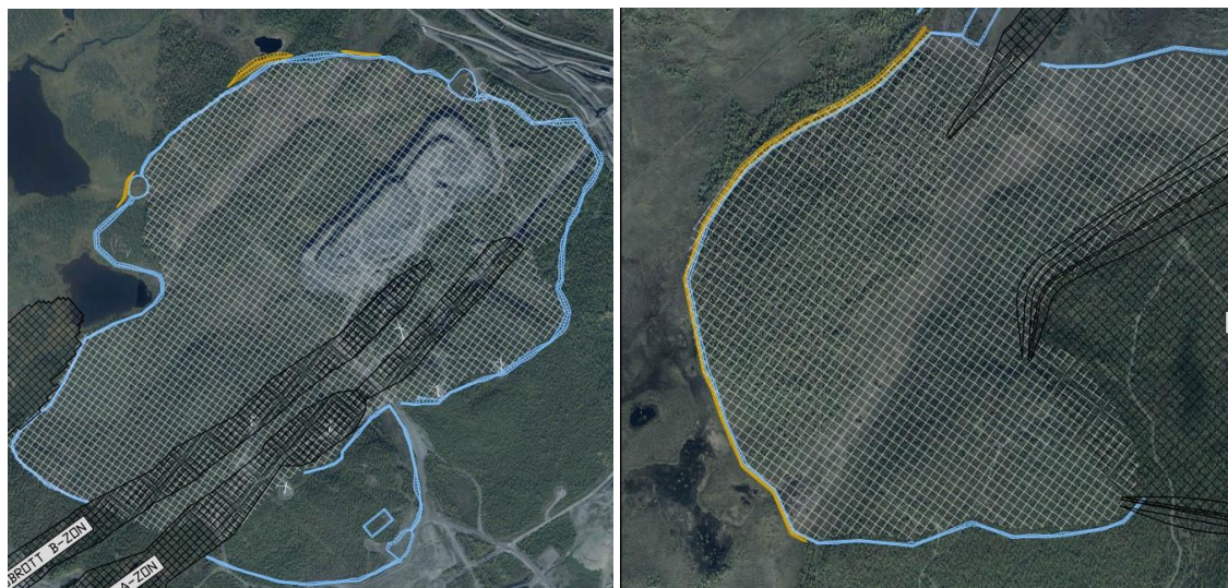
Figur 5. Exempel på placering av diken (blå) och vallar (gul) runt norra gråbergsdeponin (t.v) och södra gråbergsdeponin (t.h).
