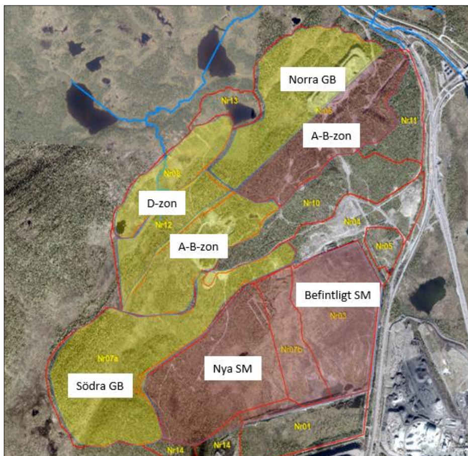
Figur 42. Grov uppdelning av delområden beroende på recipientväg. Röda delområden bedöms rinna via Luossajärvi/kanalen medan gula områden bedöms avrinna diffust norrut. GB=gråbergssupplag, SM=sandmagasin.
