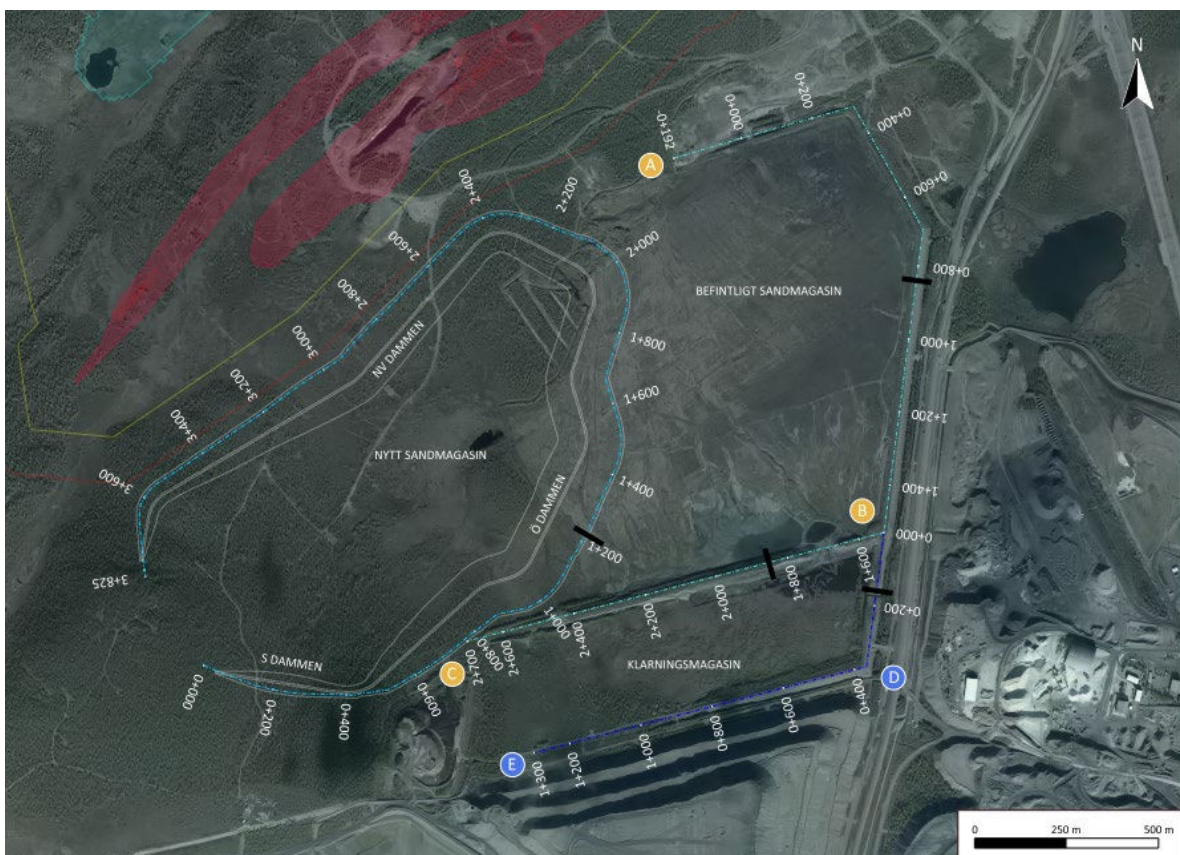
Figur 8. Översiktsplan som visar nytt sandmagasin, befintligt sand- och klarningsmagasin, gruvans dagbrott (rödsuggat område) samt de sektioner (svarta streck) för vilka stabilitetsberäkningar har utförts. Dammsträckor visualiseras med bokstäverna A-E.
