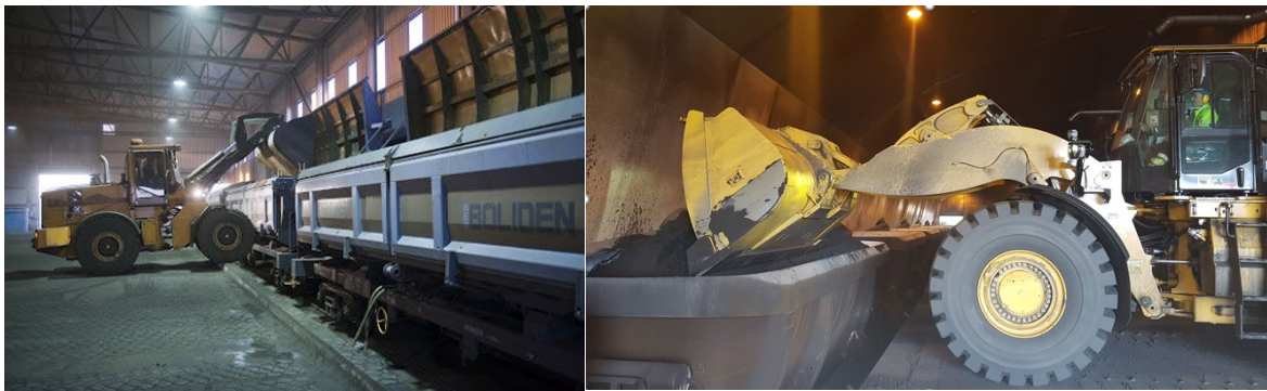
Figur 2: Lastning av koppar- och järnmalmskoncentrat i järnvägsvagnar. Lastning av kopparkoncentrat Boliden Aitik (t.v), Bildkälla: Kiruna Wagon. Lastning av järnmalmskoncentrat Kaunis Iron Pitkäjärvi (t.h), foto: Thomas Nordmark.
