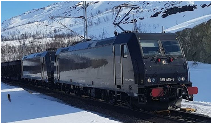
Figur 9: Multipelkopplade TRAXX lok som transporterar järnmalmskoncentrat för Kaunis Iron. Foto: Thomas Nordmark.
