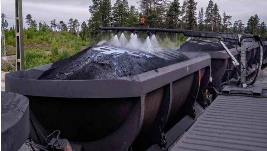
Figur 16: Limning av järnmalmkoncentrat med lignin hos Kaunis Iron. Foto: Thomas Nordmark.
