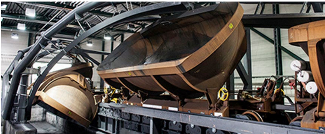
Figur 13: Lossning av järnmalmskoncentrat hos Narvik Bulkhamn. Foto: Kiruna Wagon.
