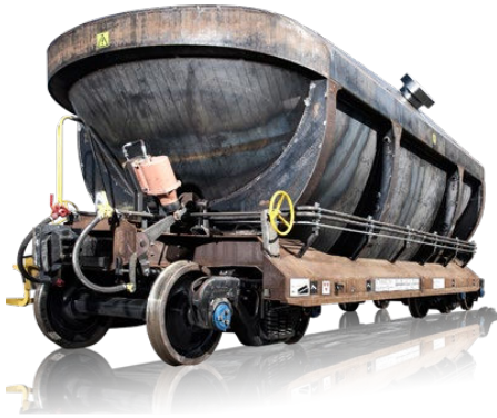
Figur 6: Vagnstyp Kaunis Iron för järnmalmskoncentrat, öppen vagn för STAX 30 ton. Bildkälla: Kiruna Wagon.
