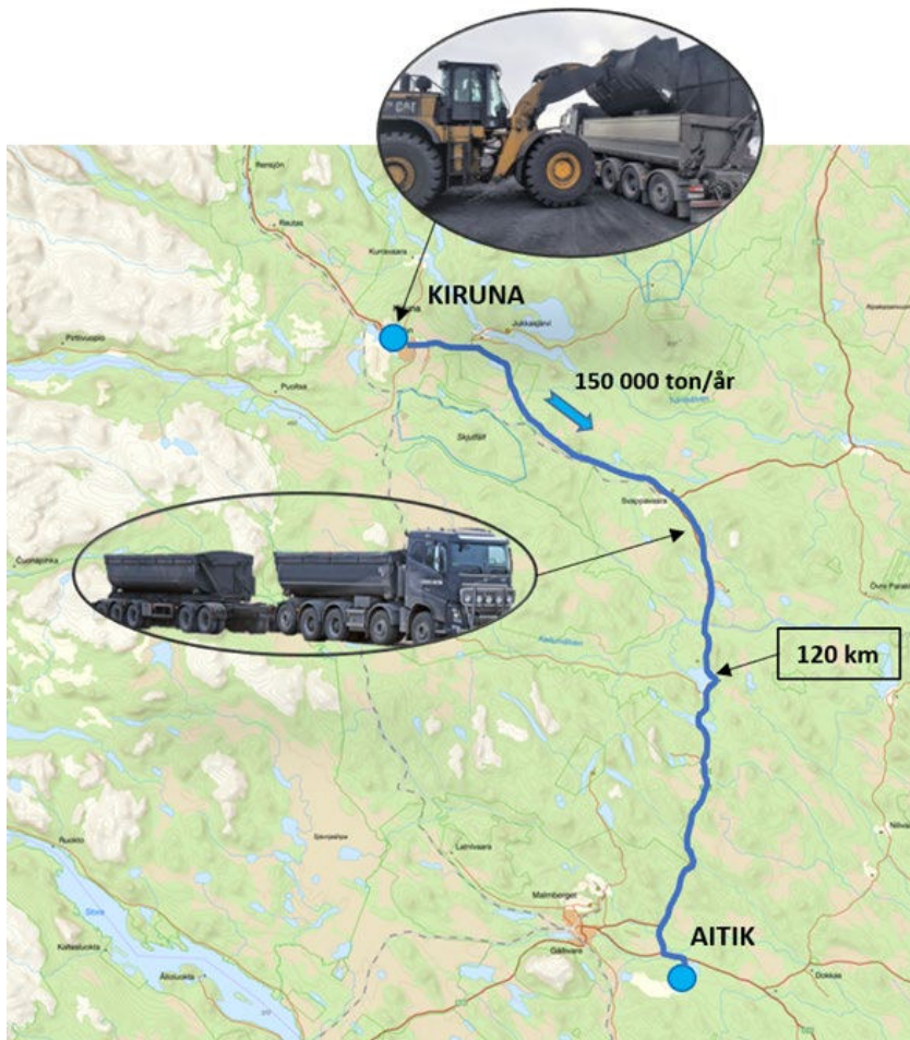
Figur 20: Koncept på transport av anrikningssand till Aitik Boliden med lastbilsekipage.
