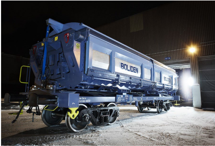
Figur 8: Vagnstyp Boliden för kopparkoncentrat, täckt vagn med STAX 25 ton. Bildkälla: Kiruna Wagon.
