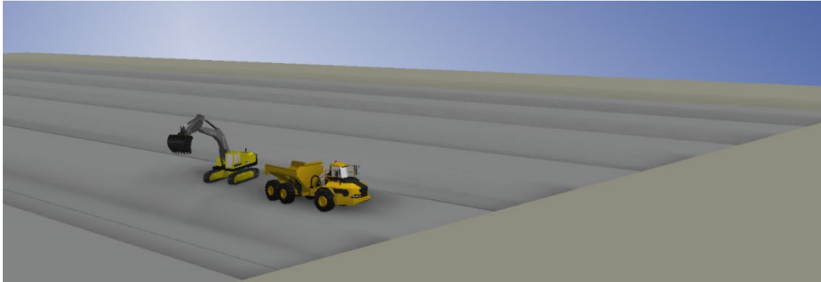
Figur 19: Koncept på utvinning av anrikningssand från existerande sandmagasin.
