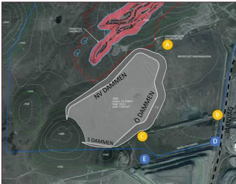
Figur 2-1. Viscarias gruvdammanläggning. Beteckning av de övriga dammdelarna. Källa: TCS.
