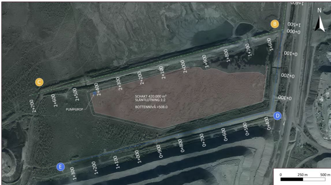
Figur 2-11. Klarningsmagasin. Översiktsvy. Källa: TCS.
