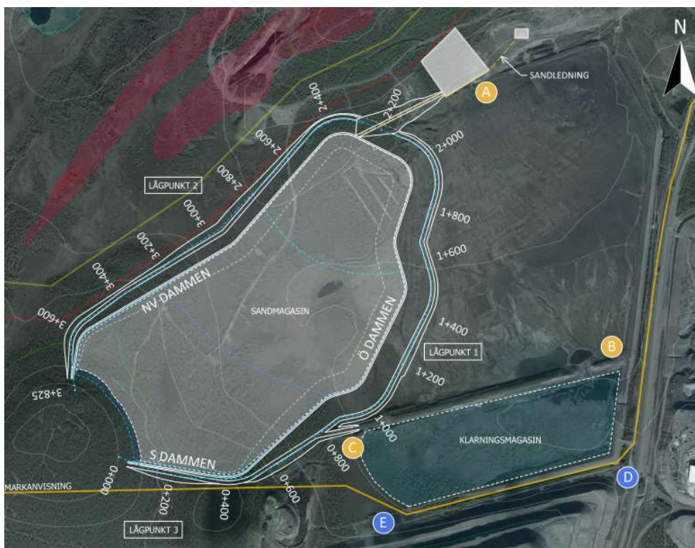
Figur 1. Översiktsplan för nytt (planerat) sandmagasin och tillhörande dammar i Viscaria samt befintliga dammar (sandmagasin: A-B, B-C och klarningsmagasin: B-D och D-E).
