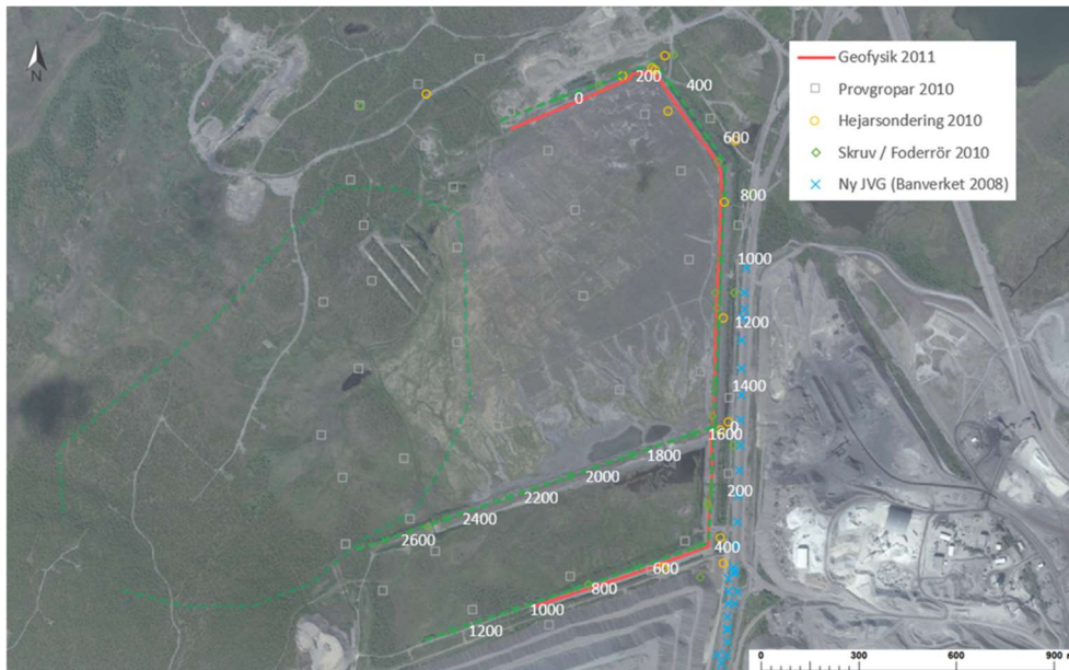
Figur 22 Plan som visar undersökningspunkternas placering vid geotekniska undersökningar 2010 (Golder, 2011b) samt undersökningar för Banverket (WSP, 2008). Grönstreckad linje visar dammlinjen för befintliga och nya dammar.
