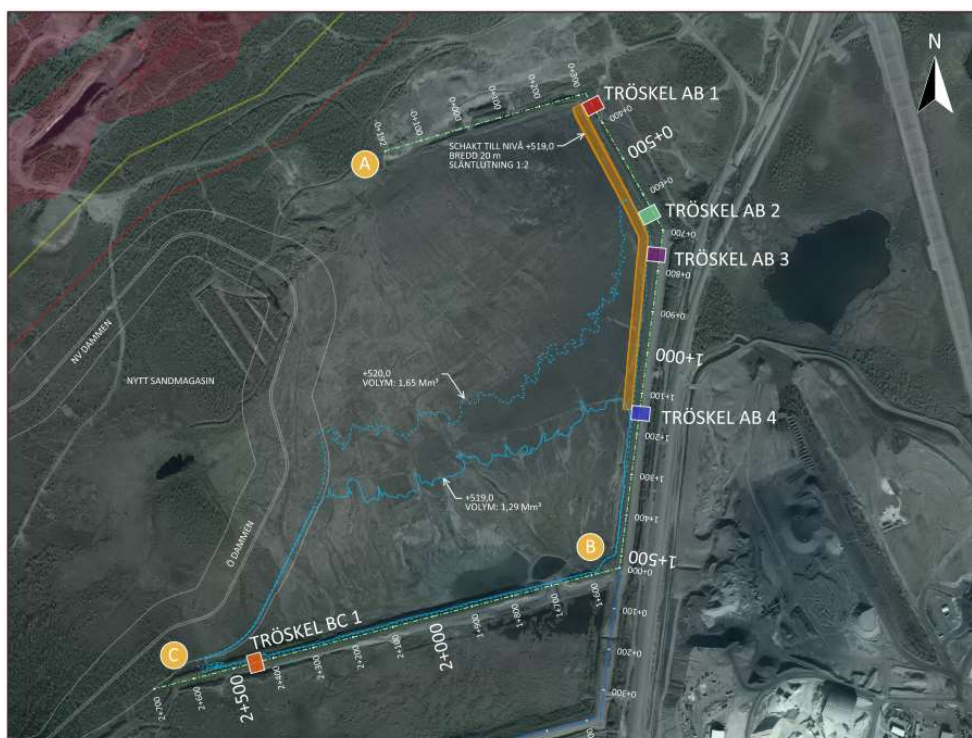
Figur 60 Plan som visar studerade alternativ för placering av nödutskovströskel i befintligt sandmagasin
