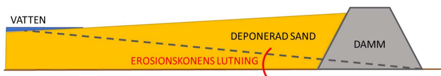
Figur 84 Sektion som principiellt visar erosionskonens lutning
