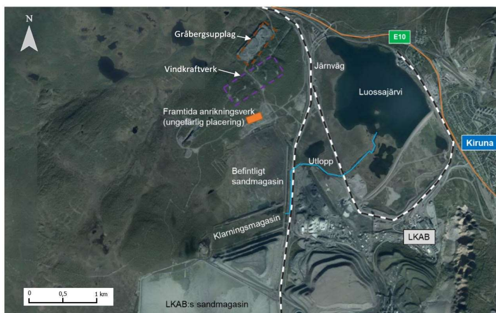
Figur 2. Översikt över befintligt sand- och klarningsmagasin vid Viscariagruvan samt närliggande infrastruktur (LKAB, järnvägen, E10 etc.).
