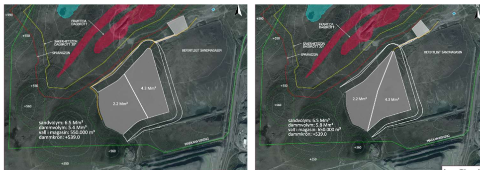
Figur 44 Översiktsplan startdammar (3 års produktion) för alternativ 1 och 3 – OPTION vall för eventuell sårhållen deponering av anrikningssand från D-malmen under de inledande 3 åren
